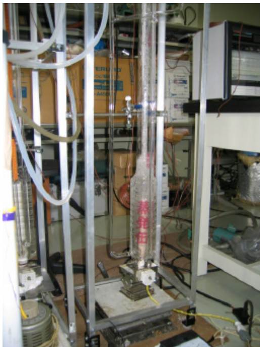
熱サイホン式雪発電装置（下部）熱源部
