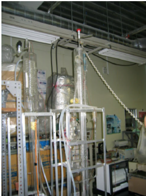
熱サイホン式雪発電装置（上部）
