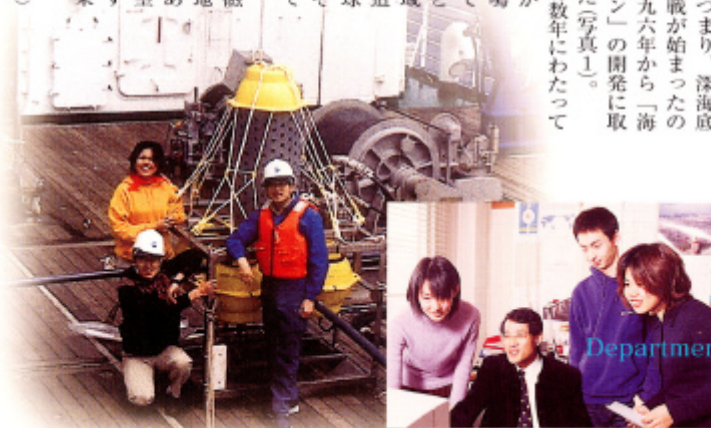
▲写真1：北西太平洋に展開中の海底長期電磁気観測ステーション。最上層の黄色いガラス球内にオーバーハウザー型絶対磁力計があり、四方に突き出ている腕は電位差測定用の直交水平ダイポール。海洋科学技術センターの大型海洋観測船「みらい」の甲板上で撮影。
