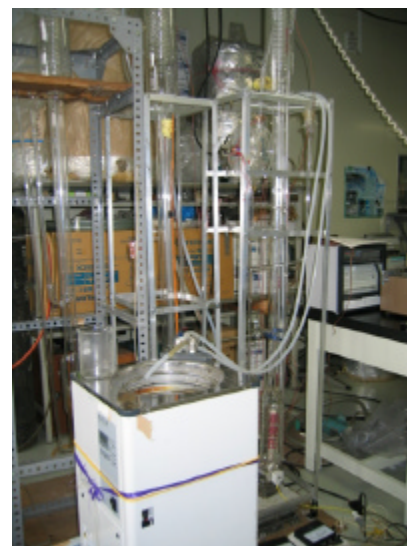
熱サイホン式雪発電装置外観
