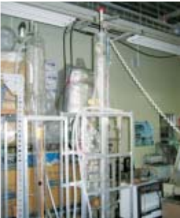
熱サイホン式雪発電装置（上部）
