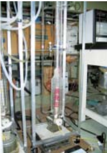
熱サイホン式雪発電装置（下部）
