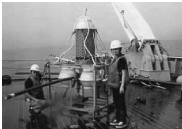
北西太平洋に敷設直前の「海底電磁気観測所」と準備に当たる富山大院生
