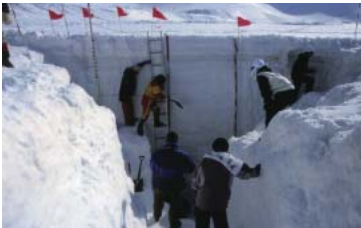
立山室堂平での7mもの積雪断面観測風景
