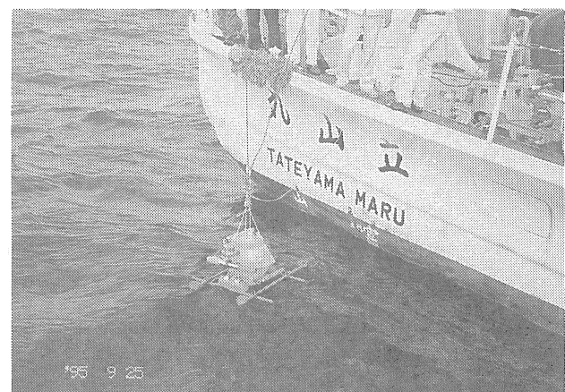
富山湾に海底地震計を沈めるところ
