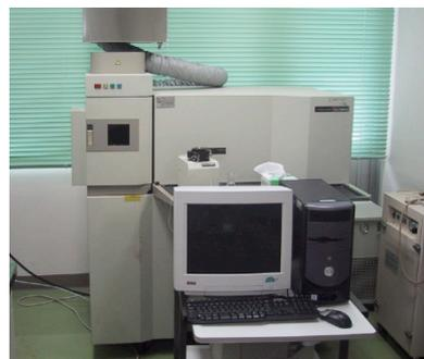
図 1 ICP 発光分光分析装置
