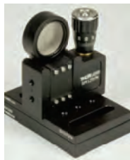
Figure 7: Mirror1 の写真。右上にマイクロスクリーウがありこれを回転させると鏡を前後に平行移動できる。
