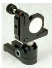
Figure 8: Mirror2 の写真。左上に黒いつまみのついたネジがる。影に隠れているがもう一つある。この2つの回転させることで鏡の向きを微調整できる。
