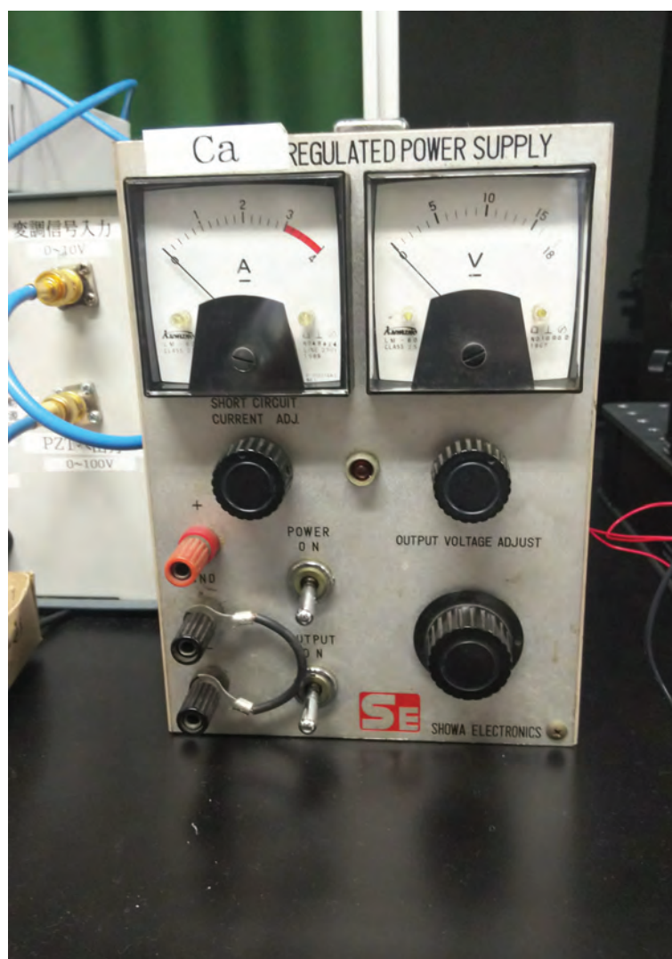
Figure 17: 電源：ヒーターの電流源となる。
