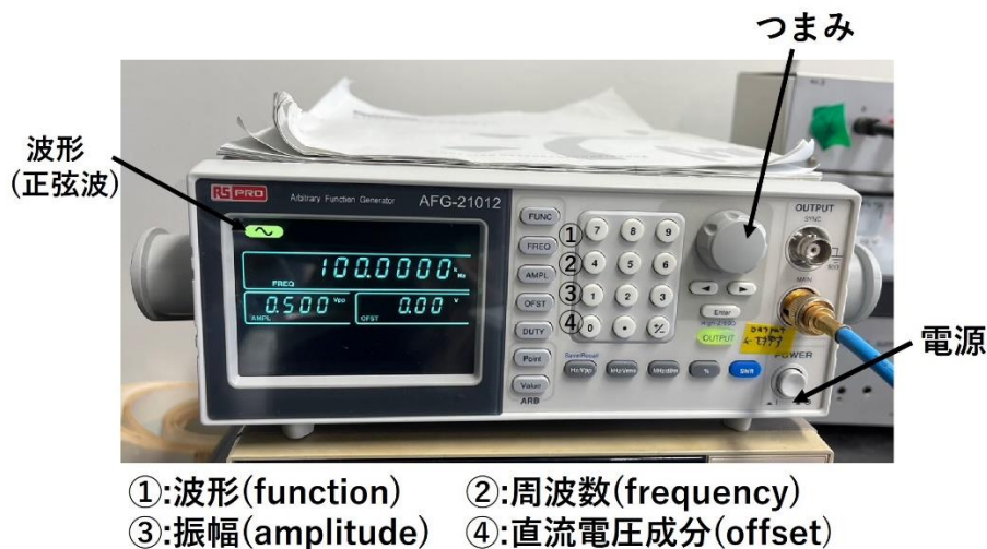
図 1 5 : ファンクションジェネレータの写真
