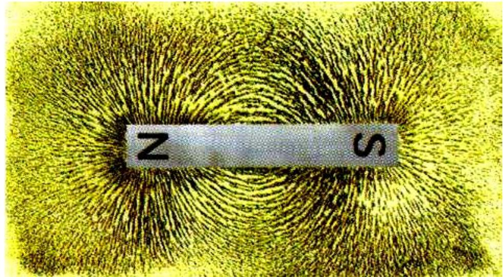
ソレノイドの外部に生じる磁場は、棒磁石の外部の磁場に似ている。
