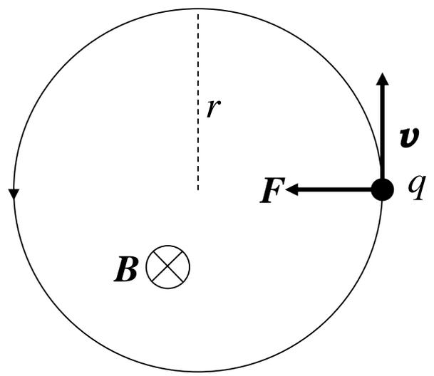
例：物理実習の比電荷の実験上の図は正電荷の場合の図。物理実習では、運動するのは電子なので、図のように円運動させるには、磁場の向きは逆でないといけない。
