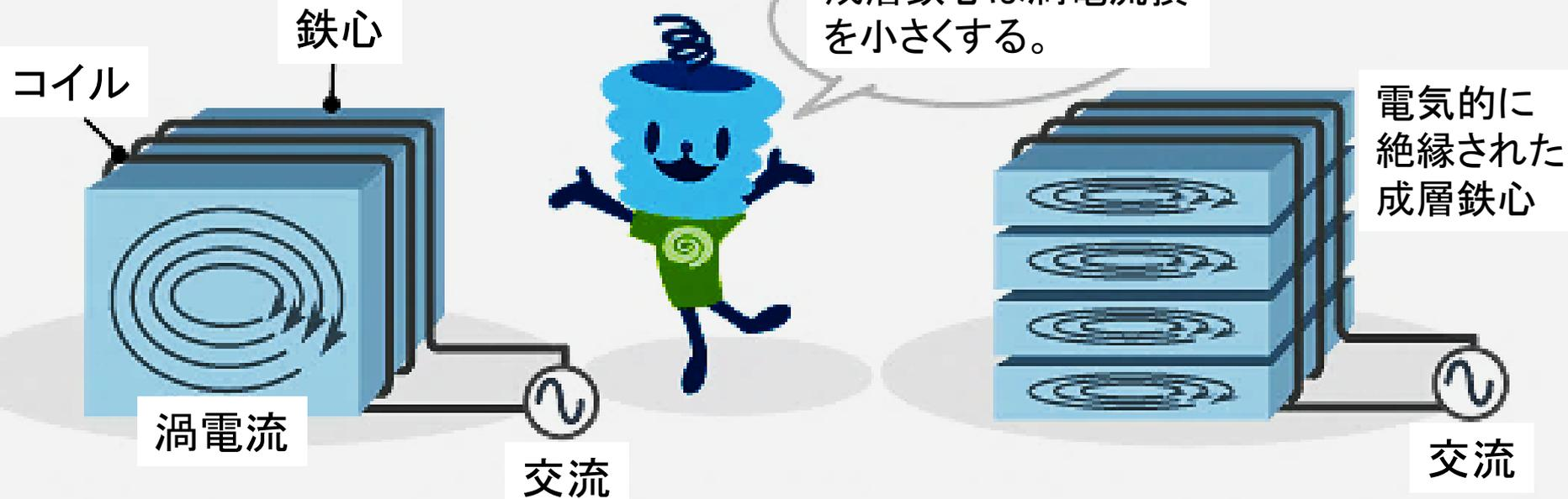
変圧器(トランス)の鉄心など、コイルに交流が流される鉄心では、磁束変化による渦電流が流れ、渦電流損(発熱)が発生する(IHクッキングヒータと似ている)。電氣的に絶縁して成層した鉄心を用いると、渦電流損を大幅に低減できる。鉄心の損失にはヒステリシス損も関係するため、ケイ素鋼などヒステリシスの小さい材料が用いられる。
