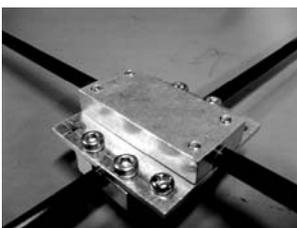
今年は、単独飛行を昨年よりも実現に近づけるために、バッテリーを機体に搭載することにした。ここで、問題となってきたのは機体の重量である。さらにモーターも、昨年より出力の大きいものにしたが、モーター1つの浮力は約300gであり4つで1200gである。それ以上の重量があると浮き上がらない。このため、支柱を軽くて丈夫なカーボンロッドにしたり、それぞれの部品の接合部分を軽いアルミを自ら加工したりすることにより、165gもある重いバッテリーを搭載したのにもかかわらず、729gという軽量化に成功した。
