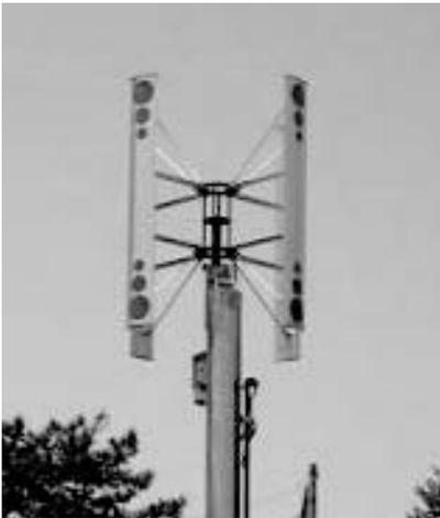
3大学協働ものづくりチームを結成し、共同作業を実施しながら卒論テーマとして、地球温暖化抑制やエネルギー問題に貢献できる高性能ダリウス型風力発電装置を製作して、性能評価を実施する。
