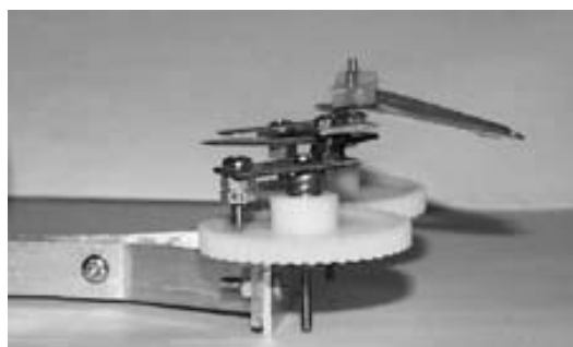
図3 組み上がったロンビック機構。PP, DP 側の各クランクが極わずかなクリアランスで組み立てられていることがわかる。
