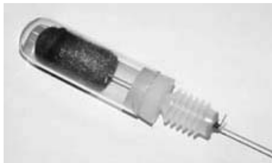
図2 ベローズ、スチールウールおよび試験管からなるエンジン本体。これだけのユニットから往復運動が生み出されるとは到底思えない。
