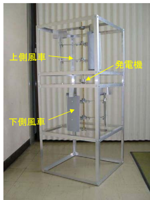
図1 風力発電装置
