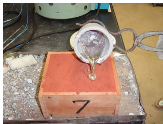
図3 アルミニウム溶湯の鑄込み
