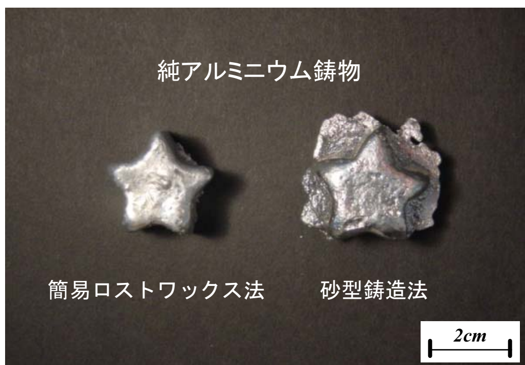
図1 簡易ロストワックス法と砂型鑄造法の比較
