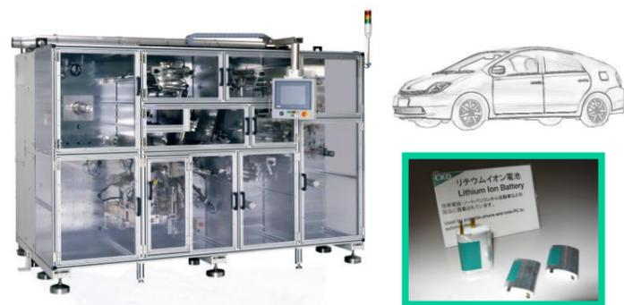
リチウムイオン電池自動捲回装置
