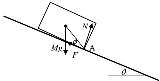
直方体に働いている力は、重力  $Mg$ , 静止摩擦力  $F$ , 垂直抗力  $N$  である。図のように転がり始める瞬間には、直方体は右下の辺でのみ斜面と接するので、静止摩擦力、垂直抗力は右下の辺で働く。斜面方向下向きに  $x$  軸, 斜面に垂直な方向に上向きに  $y$  軸をとる。力のモーメントは  $z$  成分のみ考えればよい。点 A の周りの力のモーメントを考えると、静止摩擦力、垂直抗力のモーメントはゼロ。重力のモーメント  $T_z$  は
