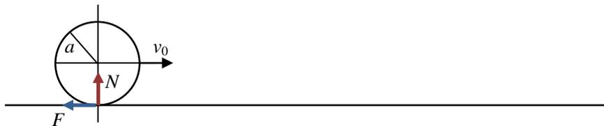
※球の回転角速度を  $\omega$  (時計回りを正とする。通常とは逆。), 並進速度を  $v$  (右向きを正とする。) とすると、滑らずに転がる条件は、
